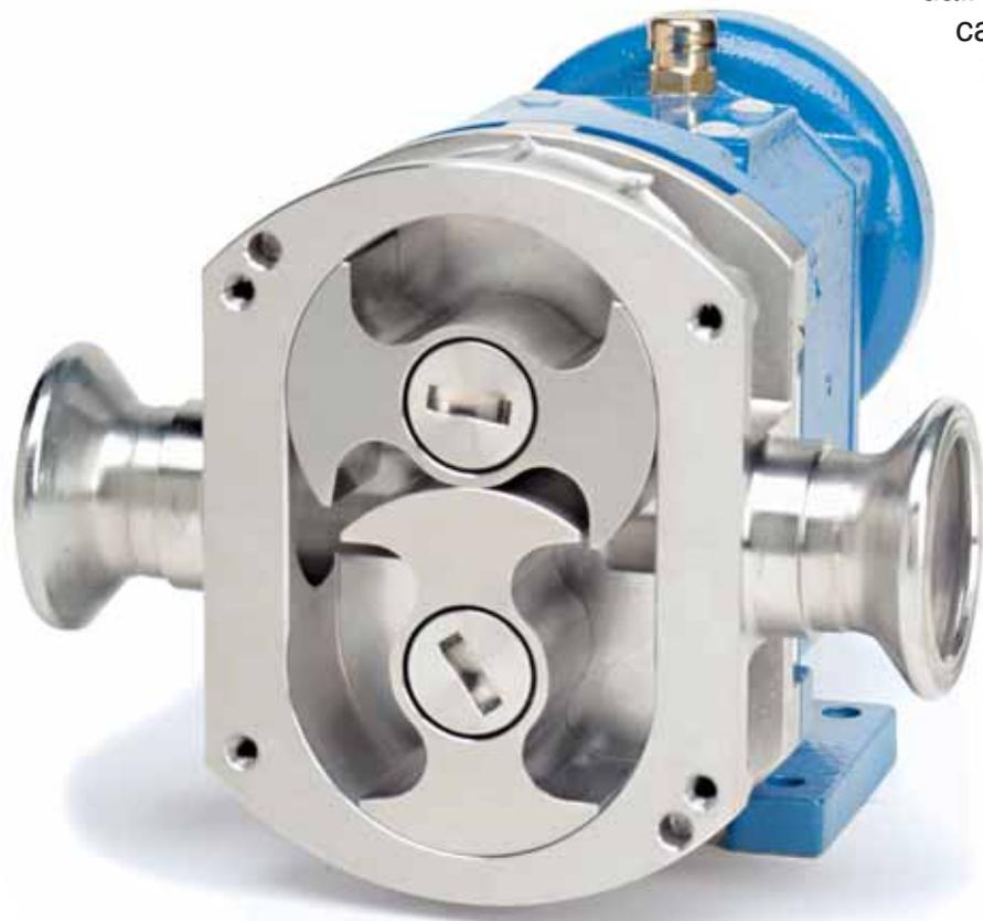
La pompa volumetrica a lobi SERIE BE deriva dall'affermata serie B di cui condivide molte caratteristiche. Il corpo pompa è in acciaio inox AISI 316 L montato su di un supporto trasmissione in ghisa protetto da vernice epossidica. Un vano di separazione netta tra corpo pompa e supporto impedisce qualsiasi contaminazione tra fluido pompato e lubrificante.
